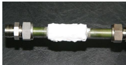
図5 電解質を塗布した円筒型MCFC
